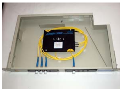
Мультиплексор выполнен в виде патч-панели 19"
